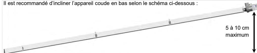
Pour le montage en position inclinée : respecter une inclinaison maximale de 30°, **extracteur en haut**. L'évacuation de l'extracteur se fait à la verticale pour faciliter le raccordement des conduits de cheminée.
